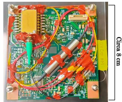
Neu entwickeltes Lichtquellenmodul
