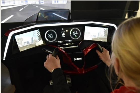
Und das in 3D-Bildgebung mit binokularer Disparität auf dem Head-up-Display. Das System ist zudem äußerst flexibel und passt die Position des Displays im Kombinator speziellen Gegebenheiten an (z. B. Auffahrt auf die Autobahn) – für noch mehr Fahrsicherheit und noch einfacheres Fahren.
