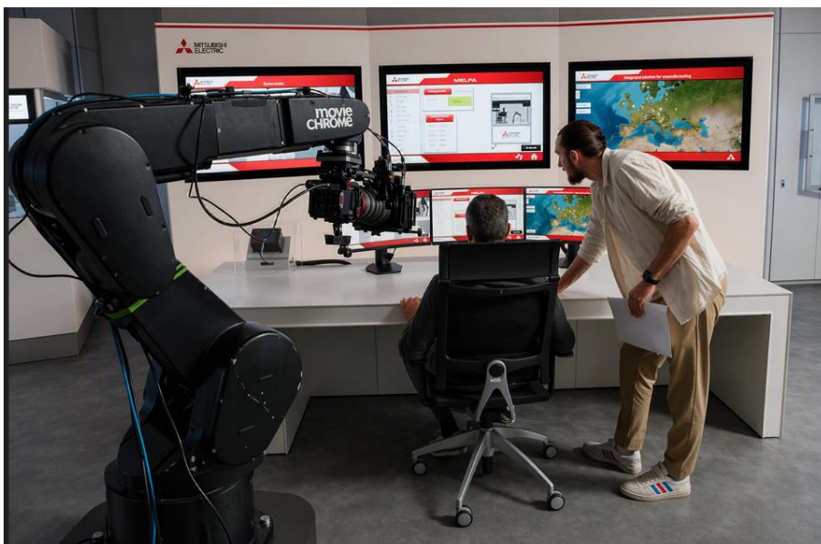
Bild 2: In direkter Interaktion mit dem Menschen. Hochpräzise Kamerabewegungen bei Film-, Werbe- und Spezialeffektproduktionen durch Industrierobotik.
