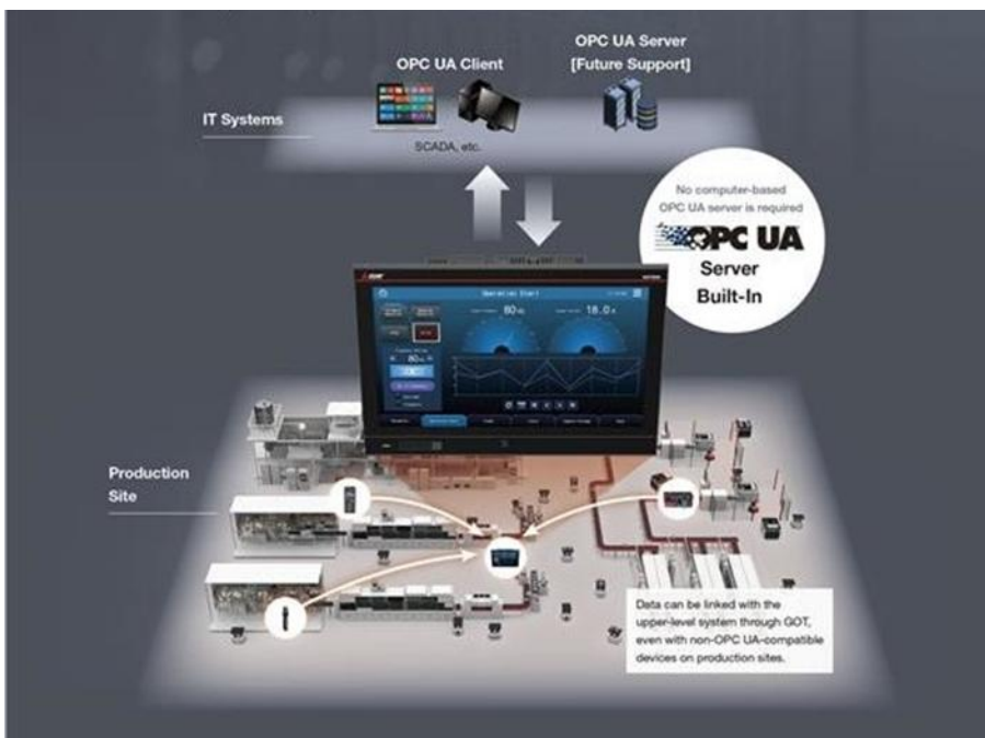
Bild 2: Mit dem integrierten OPC-UA-Server dient der GOT3000 als Gateway und ermöglicht die Datenintegration zwischen IT- und OT-Systemen.
