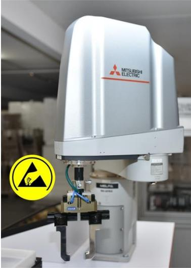
**Bild 1:** Für Elektronikanwendungen bietet Mitsubishi Electric bewährte Robotermodelle jetzt als ESD-zertifizierte Produktvariante an.
