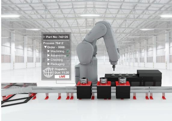
**Bild 1:** Die integrierte Intelligenz und Anbindungsmöglichkeiten des Linear Transfer Systems machen die Produktion flexibler, weil die Smart Carriages sich unterschiedlich und autonom bewegen können.
