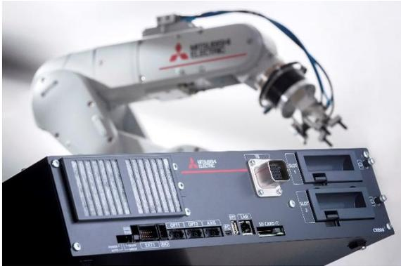
**Bild 1:** Die FR-Serie mit dem neuen CR-800-Controller sorgt mit Taktzeiten von weniger als 0,28 Sekunden für mehr Produktivität. Die schlanke Bauform bringt nicht nur ein Plus an Bewegungsfreiheit, sondern auch mehr Stabilität und Einsatzflexibilität mit sich.
