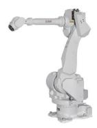
**Bild 1+2:** Heavy Champion: das neueste Mitglied der Mitsubishi Electric Roboter Familie erweitert das bestehende Portfolio der MELFA Roboter auf Traglasten bis 70 kg. [Quelle: Mitsubishi Electric Europe B.V.]
