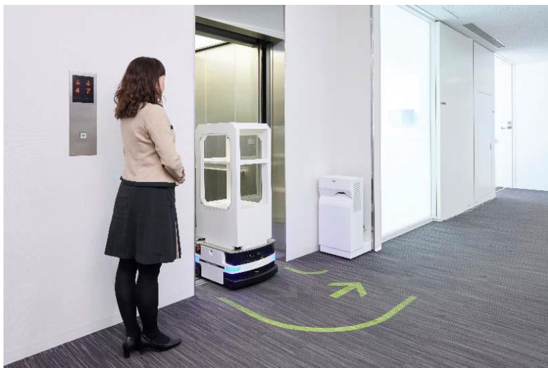
Lichtanimationen signalisieren die Bewegungen gebäudeinterner mobiler Robotersysteme
