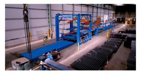
Die Anlage zum Zuschneiden und Handling der Stahlmatten braucht viel Platz, sie sechs Meter hoch und über 40 Meter lang.
