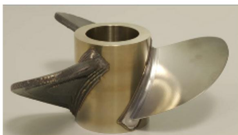
Beispiel für eine Schiffsschraube mit 300 mm Durchmesser für ein Boot, bei der Fertigungszeit und Abfall um ca. 80 % reduziert wurden
