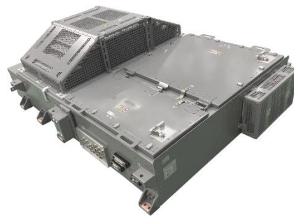
Dachmontierter Umrichter und Wechselrichter des Traktionssystems mit natürlicher Luftkühlung
