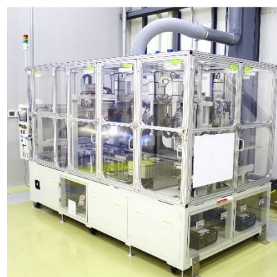
One-Piece-Flow-Galvanisieranlage zur automatischen gleitenden Auftragung einer Beschichtung
