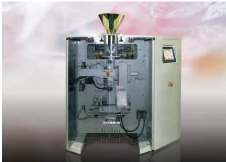
Bild 2: Schlauchbeutelmaschine: In der Schlauchbeutel-Verpackungsmaschine kommen speziell für Verpackungsmaschinen vordefinierte Funktionsblöcke zum Einsatz, über die sich die Kontrollsysteme inklusive der Bedienpanels schnell und komfortabel in Betrieb nehmen lassen.
