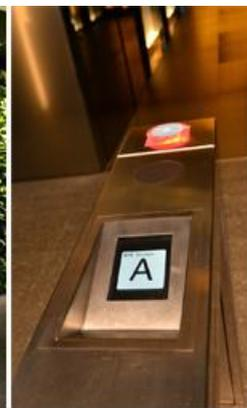
Der dem Nutzer zugewiesene Aufzug wird auf der LCD-Anzeige der Sicherheitsschranke angezeigt.
