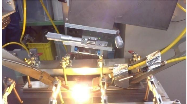
Abb. 1. Visueller Vergleich der Spritzbildung beim Faserlaserschweißen
