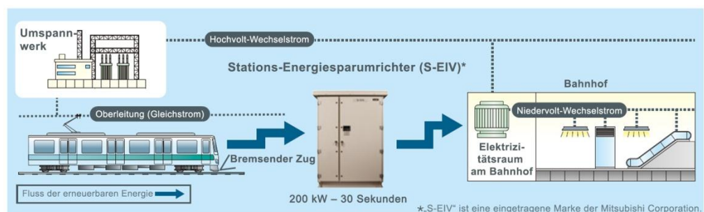
Systemkonfiguration des neuen integrierten S-EIV mit 400 V
