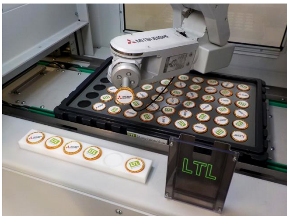
Bild 2: Bei dem schokoladenbestückten Exponat am Mitsubishi-Electric-Stand handelt es sich um einen LTL-Durchlaufstapler vom Typ DS-800, der speziell für oberflächen- oder kontursensible Bauteile, beispielsweise im Kunststoffspritzguss, entwickelt wurde.
