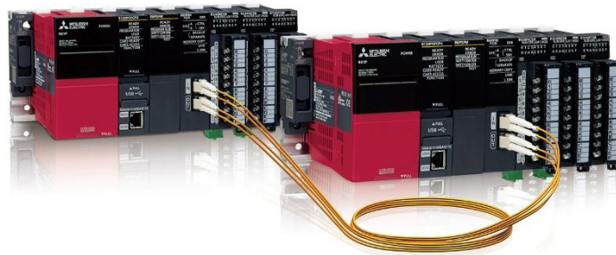
SIL 2-konforme, redundante programmierbare Steuerung der MELSEC iQ-R-Serie
