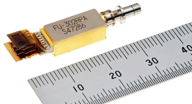
Kompakte, integrierte APD-ROSA mit 100 Gbit/s (FU-302RPA)
